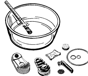
Manuelle Reinigung der demontierten Kühleinheit
