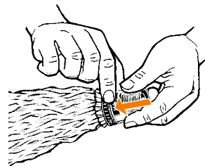
Mocowanie balonika za pomocą sprężyny
