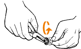
Demontage des Füllkammereinsatzes
