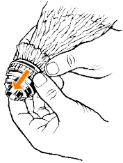
Öffnen des Schleifrings
