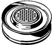
Die in die Füllkammer eingesetzte Dosierkapsel Reduzierstück
