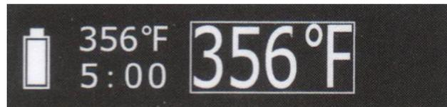
7. Auswählen der Zeit für die automatische Abschaltung. Drücken Sie die Einschalttaste und die "+"-Taste gleichzeitig für 2 Sekunden, um 5 oder 10 Minuten vor der automatischen Abschaltung zu wählen Geräte.
