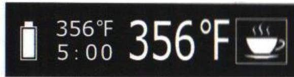
6. Schalten Sie die Temperaturanzeige um. Gleichzeitig drücken Einschalttaste und "-"-Taste und halten Sie sie 2 Sekunden lang gedrückt, um von Grad Celsius auf Grad Fahrenheit oder umgekehrt umzuschalten.
