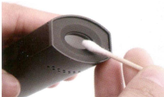
4. Nachdem Sie den Filter in Alkohol getränkt haben, entfernen Sie mit einem Wattestäbchen die Reste der Substanz. Lassen Sie alle Teile trocknen, bevor
