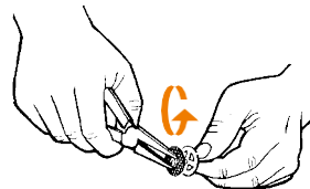
Demontáž vložky plnicí komory
